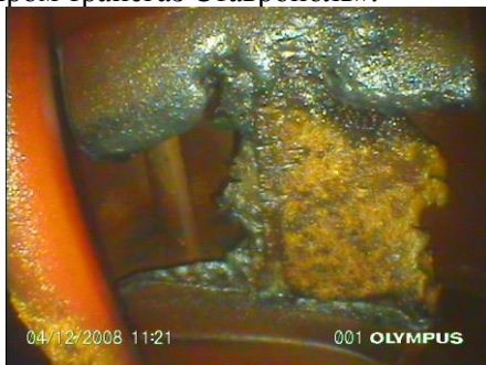
Рис. 2. Фотография лопатки 1-й ступени соплового аппарата силовой турбины ГТД НК-14СТ (ГПА ст. № 7 Рождественской ГКС)
