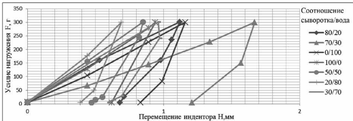
Рис. 5. Диаграмма нагружения модельных тестовых систем рисовой муки с разным уровнем замены воды на творожную сыворотку
