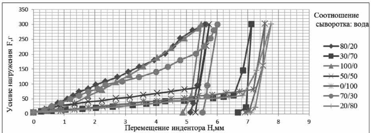
Рис. 3. Диаграмма нагружения модельных тестовых систем пшеничной муки с разным уровнем замены воды на творожную сыворотку
